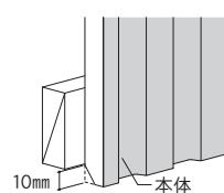
表面鋼板のすりキズ防止のため、本体の裏面側を上にして切断してください。
